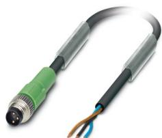
Sensor-/Aktor-Kabel, 3-polig, PVC, schwarz RAL 9005, Stecker gerade M8, Kodierung: A, auf freies Leitungsende, Kabellänge: 10 m
