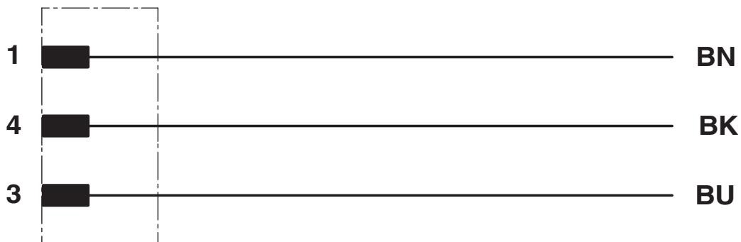
Kontaktbelegung des M8-Steckers
