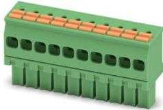
Leiterplattenstecker, Nennquerschnitt: 1,5 mm<sup>2</sup>, Farbe: grün, Nennstrom: 8 A, Bemessungsspannung (III/2): 160 V, Kontaktoberfläche: Sn, Kontaktart: Buchse, Anzahl der Reihen: 1, Polzahl: 10, Artikelfamilie: FMCOW 1,5/..-ST, Rastermaß: 3,5 mm, Anschlussart: Push-in-Federanschluss, Anschlussrichtung Leiter/Platine: -90 °, Stecksystem: COMBICON MC 1,5, Verriegelung: ohne, Befestigungsart: ohne, Verpackungsart: verpackt im Karton
