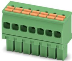
Leiterplattenstecker, Nennquerschnitt: 1,5 mm<sup>2</sup>, Farbe: grün, Nennstrom: 8 A, Bemessungsspannung (III/2): 160 V, Kontaktoberfläche: Sn, Kontaktart: Buchse, Anzahl der Reihen: 1, Polzahl: 7, Artikelfamilie: FMCOW 1,5/-ST, Rastermaß: 3,5 mm, Anschlussart: Push-in-Federanschluss, Anschlussrichtung Leiter/Platine: -90 °, Stecksystem: COMBICON MC 1,5, Verriegelung: ohne, Befestigungsart: ohne, Verpackungsart: verpackt im Karton
