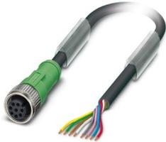
Sensor-/Aktor-Kabel, 8-polig, Spezial-TPE halogenfrei, schweißperlenbeständig, hochflexibel, grau RAL 7001, freies Leitungsende, auf Buchse gewinkelt M12, A-kodiert, Kabellänge: 5 m
