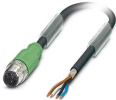
Sensor-/Aktor-Kabel, 4-polig, PUR halogenfrei, schwarzgrau RAL 7021, geschirmt, Stecker gerade M12, Kodierung: A, auf freies Leitungsende, Kabellänge: 6 m
