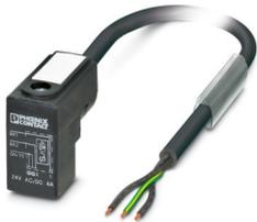
Sensor-/Aktor-Kabel, 3-polig, PUR halogenfrei, schwarzgrau RAL 7021, freies Leitungsende, auf Ventilstecker CI (9,4 mm), mit 1 LED, Beschaltung: Varistor, Kabellänge: 1,5 m
