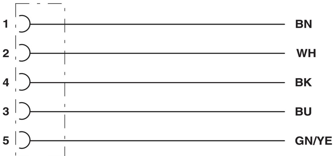
Kontaktbelegung der M12-Buchsen
