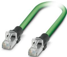
Patch-Kabel, RJ45/IP20 gerade auf RJ45/IP20 gerade, Kabellänge: 1,5 m, Polzahl: 4, 100 MBit/s, CAT5, PROFINET, 1x4xAWG22/7, SF/TQ, grün RAL 6018
