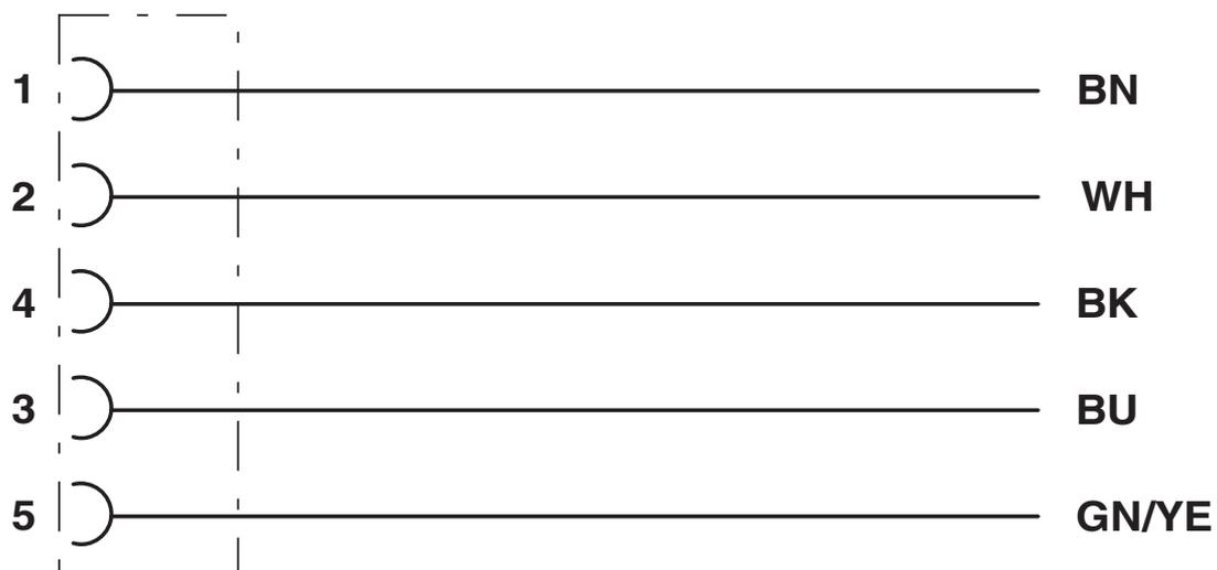
Kontaktbelegung der M12-Buchsen
