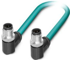
Netzwerkkabel, Ethernet CAT5 (100 MBit/s), 4-polig, PUR halogenfrei, wasserblau RAL 5021, geschirmt (Advanced Shielding Technology), Stecker gewinkelt M12, Kodierung: D / IP67, auf Stecker gewinkelt M12, Kodierung: D / IP67, Kabellänge: 0,9 m
