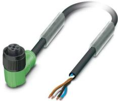
Sensor-/Aktor-Kabel, 4-polig, PUR halogenfrei, schwarzgrau RAL 7021, freies Leitungsende, auf Buchse gewinkelt M12, Kodierung: A, Kabellänge: 1,5 m, mit Kunststoffrändel
