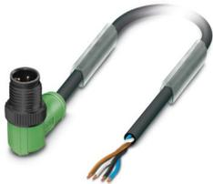
Sensor-/Aktor-Kabel, 4-polig, PUR halogenfrei, schwarzgrau RAL 7021, Stecker gewinkelt M12, Kodierung: A, auf freies Leitungsende, Kabellänge: 5 m, mit Kunststofffrüdel
