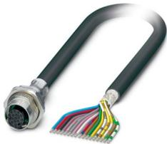
Gerätesteckverbinder Hinterwand, Universal, 17-polig, PVC/PVC, schwarz RAL 9005, geschirmt, Buchse, gerade, M12-SPEEDCON, A-Kodierung, auf freies Leitungsende, Kabelanschluss, Kabellänge: 2 m, 0,14 mm<sup>2</sup>, PVC schwarz, dieser Artikel ist voraussichtlich ab 2026-Q2 nach RoHS II ohne Ausnahme 6c (Pb < 0,1 %) bleifrei, auf Anfrage ist eine bleifreie Alternative vorab möglich
