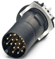
Kontaktträger, 17-polig, Stift, gerade, M12, A-Kodierung, THR-Lötanschluss, dieser Artikel ist voraussichtlich ab 2025-Q3 nach RoHS II ohne Ausnahme 6c (Pb < 0,1 %) bleifrei, auf Anfrage ist eine bleifreie Alternative vorab möglich
