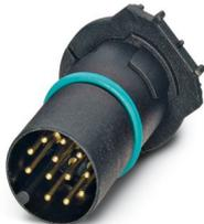
Kontaktträger, 12-polig, Stift, gerade, M12, A-Kodierung, THR-Lötanschluss, dieser Artikel ist voraussichtlich ab 2025-Q3 nach RoHS II ohne Ausnahme 6c (Pb < 0,1 %) bleifrei, auf Anfrage ist eine bleifreie Alternative vorab möglich
