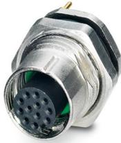
Gerätesteckverbinder Hinterwand, 12-polig, Buchse, gerade, M12-SPEEDCON, A-Kodierung, Wellenlöten, dieser Artikel ist voraussichtlich ab 2026-Q1 nach RoHS II ohne Ausnahme 6c (Pb < 0,1 %) bleifrei, auf Anfrage ist eine bleifreie Alternative vorab möglich
