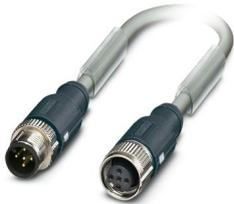
Bussystem-Kabel, CANopen®, 5-polig, PUR halogenfrei, silbergrau RAL 7001, geschirmt, Stecker gerade M12, Kodierung: A, auf Buchse gerade M12, Kodierung: A, Kabellänge: 8 m, Steckverbinder ungeschirmt
