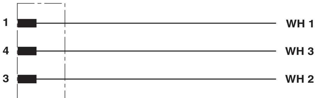
Kontaktbelegung des M12-Steckers
