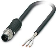
Sensor-/Aktor-Kabel, 3-polig, PE-X halogenfrei, schwarz, geschirmt, Stecker gerade M12 SPEEDCON, Kodierung: A, auf freies Leitungsende, Kabellänge: 0,4 m, für Bahnanwendungen
