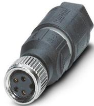
Steckverbinder, Universal, 4-polig, Buchse gerade M8, Kodierung: A, Schneidklemmanschluss, Rändelmaterial: Zinkdruckguss, vernickelt, Leitungsaußendurchmesser 2,5 mm ... 5 mm
