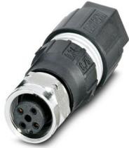
Steckverbinder, Universal, 4-polig, Buchse gerade M12, Kodierung: A, Schneidklemmanschluss, Rändelmaterial: Edelstahl 1.4404, Leitungsaußendurchmesser 4 mm ... 8 mm
