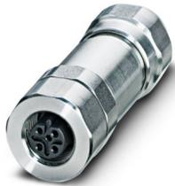
Steckverbinder, 5-polig, geschirmt, Buchse gerade M12, Kodierung: B, Schraubanschluss, Rändelmaterial: Edelstahl 1.4404, Kabelverschraubung M16, Leitungsaußendurchmesser 5,5 mm ... 8,6 mm
