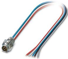
Gerätesteckverbinder Vorderwand, DeviceNet™, 5-polig, Stift, gerade, M8, Vorderwandmontage, M8 x 0,5, Einzellitzen, Kabellänge: 0,5 m, 0,25 mm<sup>2</sup>, PVC-Litze
