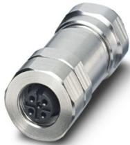
Steckverbinder, 5-polig, geschirmt, Buchse gerade M12, Kodierung: A, Schraubanschluss, Rändelmaterial: Edelstahl 1.4404, Kabelverschraubung M16, Leitungsaußendurchmesser 5,5 mm ... 8,6 mm
