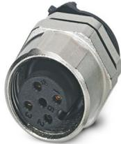
Gerätesteckverbinder Hinterwand, 4-polig, Buchse, gerade, M12-SPEEDCON, A-Kodierung, THR-Lötanschluss, dieser Artikel ist voraussichtlich ab 2026-Q2 nach RoHS II ohne Ausnahme 6c (Pb < 0,1 %) bleifrei, auf Anfrage ist eine bleifreie Alternative vorab möglich
