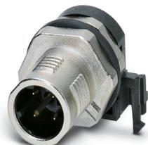
Gerätesteckverbinder Hinterwand, 4-polig, Stift, gewinkelt, M12-SPEEDCON, A-Kodierung, THR- und Wellenlöt, dieser Artikel ist voraussichtlich ab 2026-Q2 nach RoHS II ohne Ausnahme 6c (Pb < 0,1 %) bleifrei, auf Anfrage ist eine bleifreie Alternative vorab möglich
