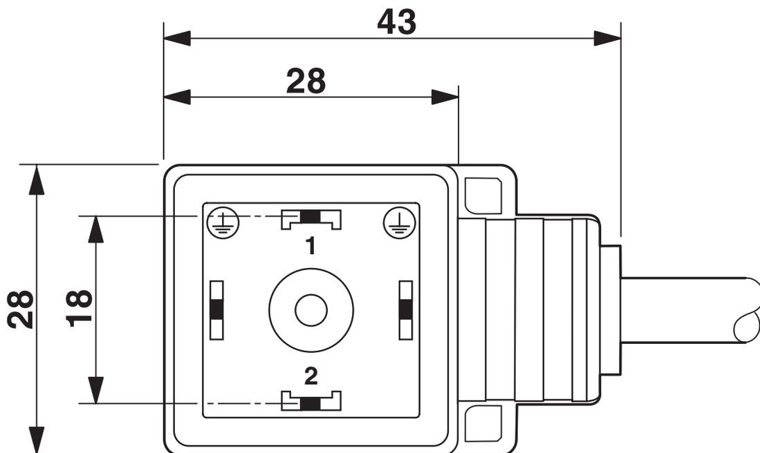
Ventilstecker, Bauform A
