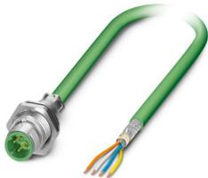
Bussystem-Einbaustecker, PROFINET, 4-polig, M12, geschirmt, D-kodiert, SPEEDCON, Hinterwand-/Schraubmontage mit Pg9-Gewinde, mit 2,0 m Buskabel, 2 x 2 x 0,34 mm<sup>2</sup>
