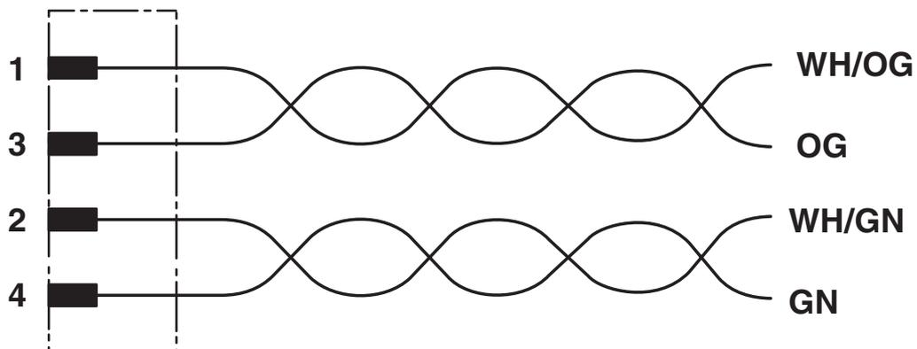
Kontaktbelegung des M12-Steckers
