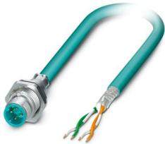
Bussystem-Einbaustecker, Ethernet, 4-polig, M12-SPEEDCON, geschirmt, D-kodiert, Hinterwand-/Schraubmontage mit Pg9-Gewinde, mit 1,0 m Buskabel, 2 x 2 x 0,2 mm<sup>2</sup>
