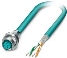
Gerätesteckverbinder Hinterwand, Ethernet CAT5 (100 MBit/s), Ethernet, 4-polig, Buchse, gerade, M12-SPEEDCON, D-Kodierung, auf freies Leitungsende, Kabelanschluss, Kabellänge: 0,5 m, dieser Artikel ist voraussichtlich ab 2027-Q1 nach RoHS II ohne Ausnahme 6c (Pb < 0,1 %) bleifrei, auf Anfrage ist eine bleifreie Alternative vorab möglich
