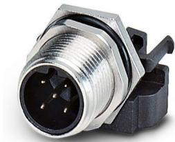
Sensor-/Aktor-Einbaustecker, 5-polig, M12, geschirmt, B-kodiert, Hinterwand-/Schraubmontage mit M12-Gewinde, mit geradem Lötanschluss
