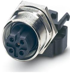
Sensor-/Aktor-Einbausteckverbinder, Buchse, 5-polig, M12, geschirmt, B-kodiert, Hinterwand-/Schraubmontage mit M12-Gewinde, verdrehgeschützt, mit geradem Lötanschluss
