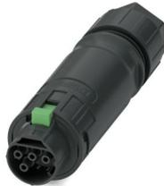
Kupplungssteckverbinder, Artikelfamilie: ArcZero, Farbe: schwarz, Polzahl: 3, Aderquerschnitt min.: 1,5 mm<sup>2</sup>, Aderquerschnitt max.: 6 mm<sup>2</sup>, Bemessungsspannung: 400 VDC, Bemessungsstrom: 20 A, Anschlussart: Schraubanschluss, Kabeldurchmesser min.: 8 mm, Kabeldurchmesser max.: 21 mm, Maximale Last beim Trennen: 8 kW, Anwendungsbereich: DC-Grid
