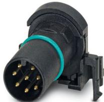
Kontaktträger, 8-polig, Stift, gewinkelt, M12, A-Kodierung, Wellenlöten, Artikel ist bleifrei nach RoHS II ohne Ausnahme 6c (Pb < 0,1 %)
