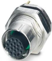
Gerätesteckverbinder Hinterwand, 17-polig, Buchse, gerade, M12-SPEEDCON, A-Kodierung, Wellenlöt, dieser Artikel ist voraussichtlich ab 2026-Q2 nach RoHS II ohne Ausnahme 6c (Pb < 0,1 %) bleifrei, auf Anfrage ist eine bleifreie Alternative vorab möglich
