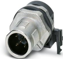
Gerätesteckverbinder Hinterwand, 5-polig, Stift, gewinkelt, M12-SPEEDCON, A-Kodierung, THR- und Wellenlöt, dieser Artikel ist voraussichtlich ab 2026-Q2 nach RoHS II ohne Ausnahme 6c (Pb < 0,1 %) bleifrei, auf Anfrage ist eine bleifreie Alternative vorab möglich
