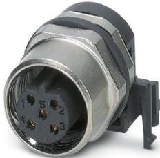
Gerätesteckverbinder Hinterwand, 5-polig, Buchse, gewinkelt, M12-SPEEDCON, B-Kodierung, THR- und Wellenlötens, dieser Artikel ist voraussichtlich ab 2026-Q2 nach RoHS II ohne Ausnahme 6c (Pb < 0,1 %) bleifrei, auf Anfrage ist eine bleifreie Alternative vorab möglich
