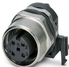
Gerätesteckverbinder Hinterwand, 4-polig, Buchse, gewinkelt, M12-SPEEDCON, A-Kodierung, THR- und Wellenlöt, dieser Artikel ist voraussichtlich ab 2026-Q2 nach RoHS II ohne Ausnahme 6c (Pb < 0,1 %) bleifrei, auf Anfrage ist eine bleifreie Alternative vorab möglich
