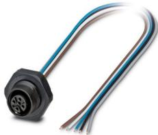
Gerätesteckverbinder Hinterwand, Universal, 5-polig, Buchse, gerade, M12-Standard, A-Kodierung, auf freies Leitungsende, Einzellitzen, Kabellänge: 0,5 m, 0,34 mm<sup>2</sup>, TPE-Litze
