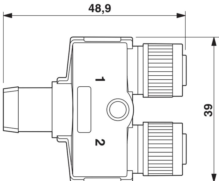
Y-Verteiler, 2 x Buchse M12 x 1
