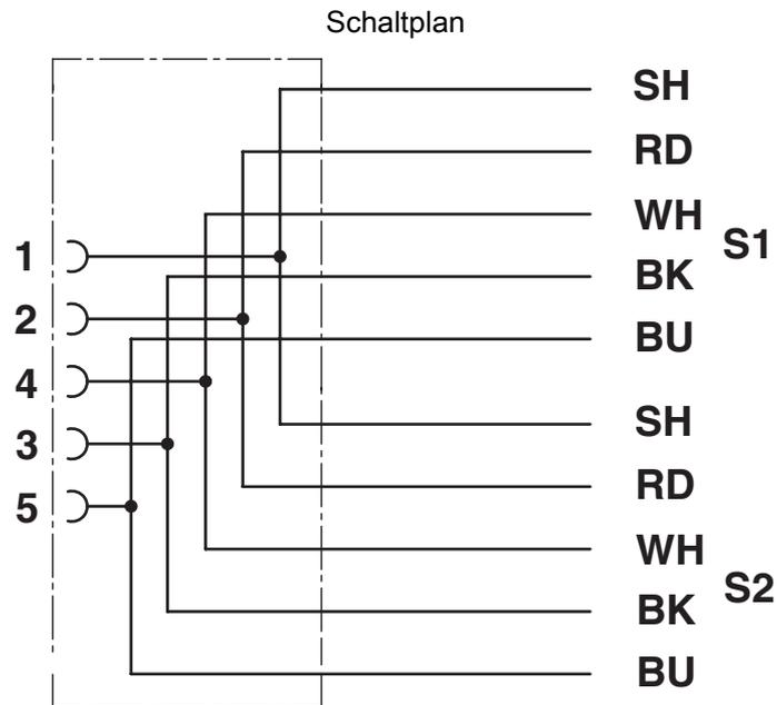
Kontaktbelegung der M12-Buchse
