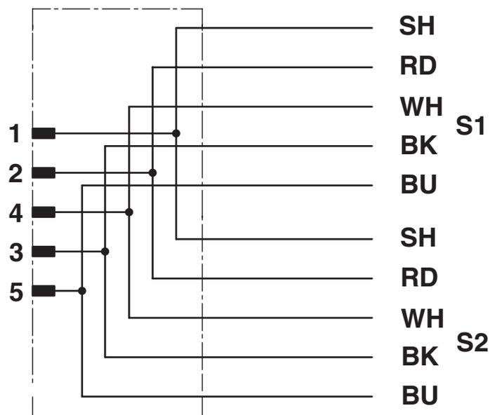
Kontaktbelegung des M12-Steckers
