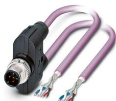
Bussystem-Kabel, CANopen®, DeviceNet™, 5-polig, PUR halogenfrei, violett RAL 4001, geschirmt, Stecker gerade M12 SPEEDCON, Kodierung: A, auf freies Leitungsende und freies Leitungsende, Kabellänge: 15 m, Steckverbinder ungeschirmt, Schirm auf Pin 1 aufgelegt
