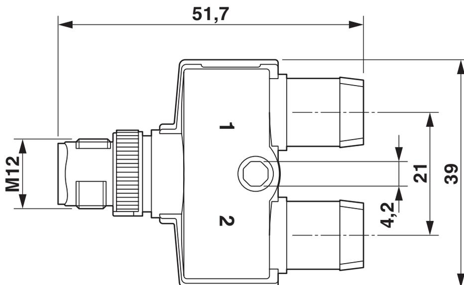
Stecker M12-SPEEDCON, Y-Verteiler
