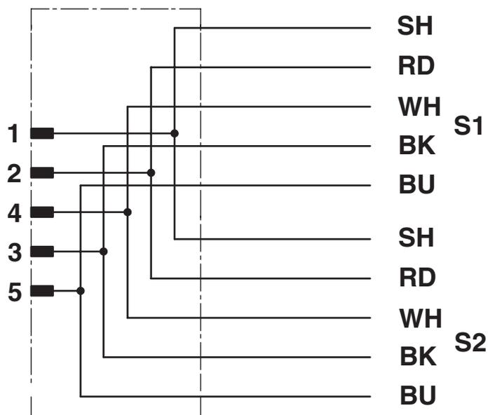
Kontaktbelegung des M12-Steckers
