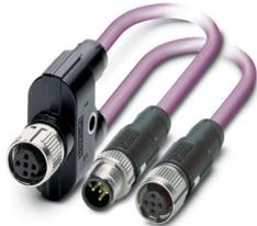
Bussystem-Kabel, CANopen®, DeviceNet™, 5-polig, PUR halogenfrei, violett RAL 4001, geschirmt, Buchse gerade M12 SPEEDCON, Kodierung: A, auf Buchse gerade M12 SPEEDCON, Kodierung: A und Stecker gerade M12 SPEEDCON, Kodierung: A, Kabellänge: 5 m, alle Steckverbinder ungeschirmt, Schirm auf Pin 1 aufgelegt
