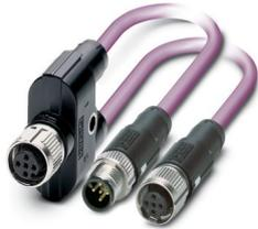
Bussystem-Kabel, CANopen®, DeviceNet™, 5-polig, PUR halogenfrei, violett RAL 4001, geschirmt, Buchse gerade M12 SPEEDCON, Kodierung: A, auf Buchse gerade M12 SPEEDCON, Kodierung: A und Stecker gerade M12 SPEEDCON, Kodierung: A, Kabellänge: 0,3 m, alle Steckverbinder ungeschirmt, Schirm auf Pin 1 aufgelegt
