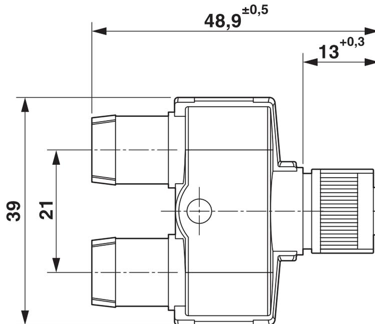
Buchse M12-SPEEDCON, Y-Verteiler
