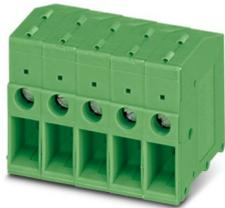
Leiterplattenklemme, Nennstrom: 32 A, Bemessungsspannung (III/2): 630 V, Nennquerschnitt: 4 mm<sup>2</sup>, Anzahl der Reihen: 1, Polzahl pro Reihe: 4, Artikelfamilie: FRONT 4-H, Rastermaß: 7,62 mm, Anschlussart: Frontschraubanschluss, Montage: Wellenlöten, Anschlussrichtung Leiter/Platine: 0 °, Farbe: grün, Pin-Layout: Lineares Pinning, Pinlänge [P]: 5 mm, Anzahl der Lötpins pro Potenzial: 2, Verpackungsart: verpackt im Karton
