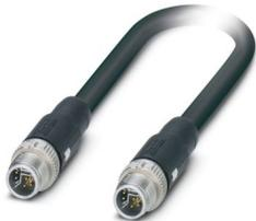
Hybridkabel, Ethernet Hybrid CAT5 (100 MBit/s), 8-polig, PUR halogenfrei, schwarz RAL 9005, geschirmt, Stecker gerade M12, auf Stecker gerade M12, Kabellänge: 1,5 m, Power with Ethernet (PWE)
