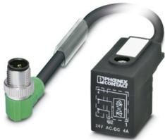
Sensor-/Aktor-Kabel, 3-polig, PUR halogenfrei, schwarzgrau RAL 7021, Stecker gewinkelt M12 SPEEDCON, Kodierung: A, mit 1 LED, auf Ventilstecker B (10 mm), mit 1 LED, Beschaltung: Z-Diode, Kabellänge: 0,3 m
