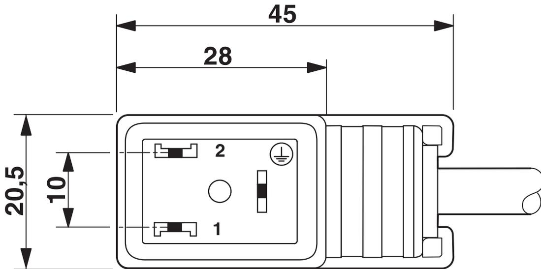
Ventilstecker, Bauform B
