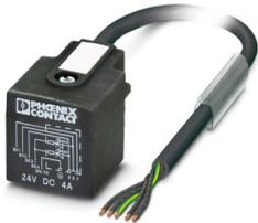
Sensor-/Aktor-Kabel, 5-polig, PUR halogenfrei, schwarzgrau RAL 7021, freies Leitungsende, auf Ventilstecker AD (Druckschalter), mit 2 LEDs, Beschaltung: unbeschaltet, Kabellänge: 3 m
