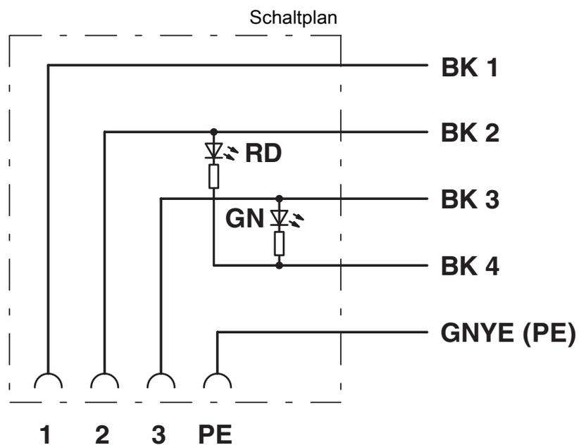
Kontaktbelegung des Ventilsteckers
