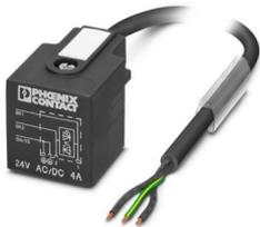
Sensor-/Aktor-Kabel, 3-polig, PUR halogenfrei, schwarzgrau RAL 7021, freies Leitungsende, auf Ventilstecker A, mit 1 LED, Beschaltung: Z-Diode, Kabellänge: 10 m
