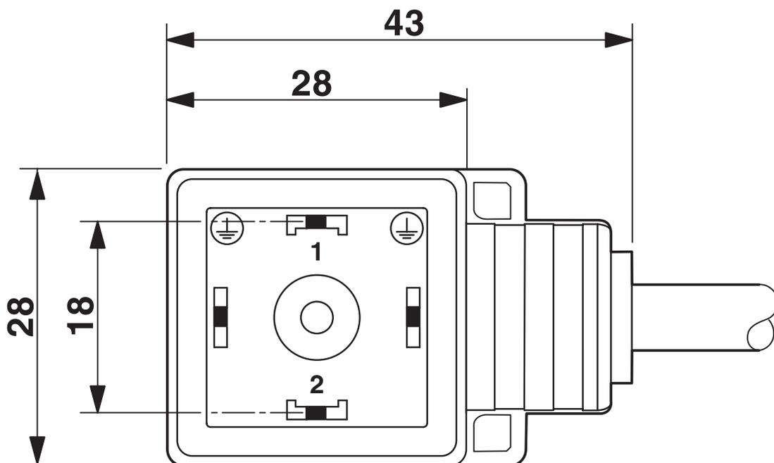
Ventilstecker, Bauform A
