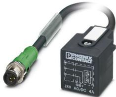
Sensor-/Aktor-Kabel, 3-polig, PUR halogenfrei, schwarzgrau RAL 7021, Stecker gerade M12 SPEEDCON, Kodierung: A, auf Ventilstecker A, mit 1 LED, Beschaltung: Z-Diode, Kabellänge: 1,5 m
